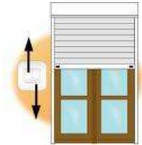
Les volets roulants sont pré réglés en usine afin de s'arrêter automatiquement en fin de course haut et bas, Vous pouvez toujours stopper l'ouverture ou la fermeture à une position intermédiaire avec l'interrupteur, Le boîtier de commande fourni est à poser en applique. Un croquis de branchement est disponible ( voir notice de pose )
