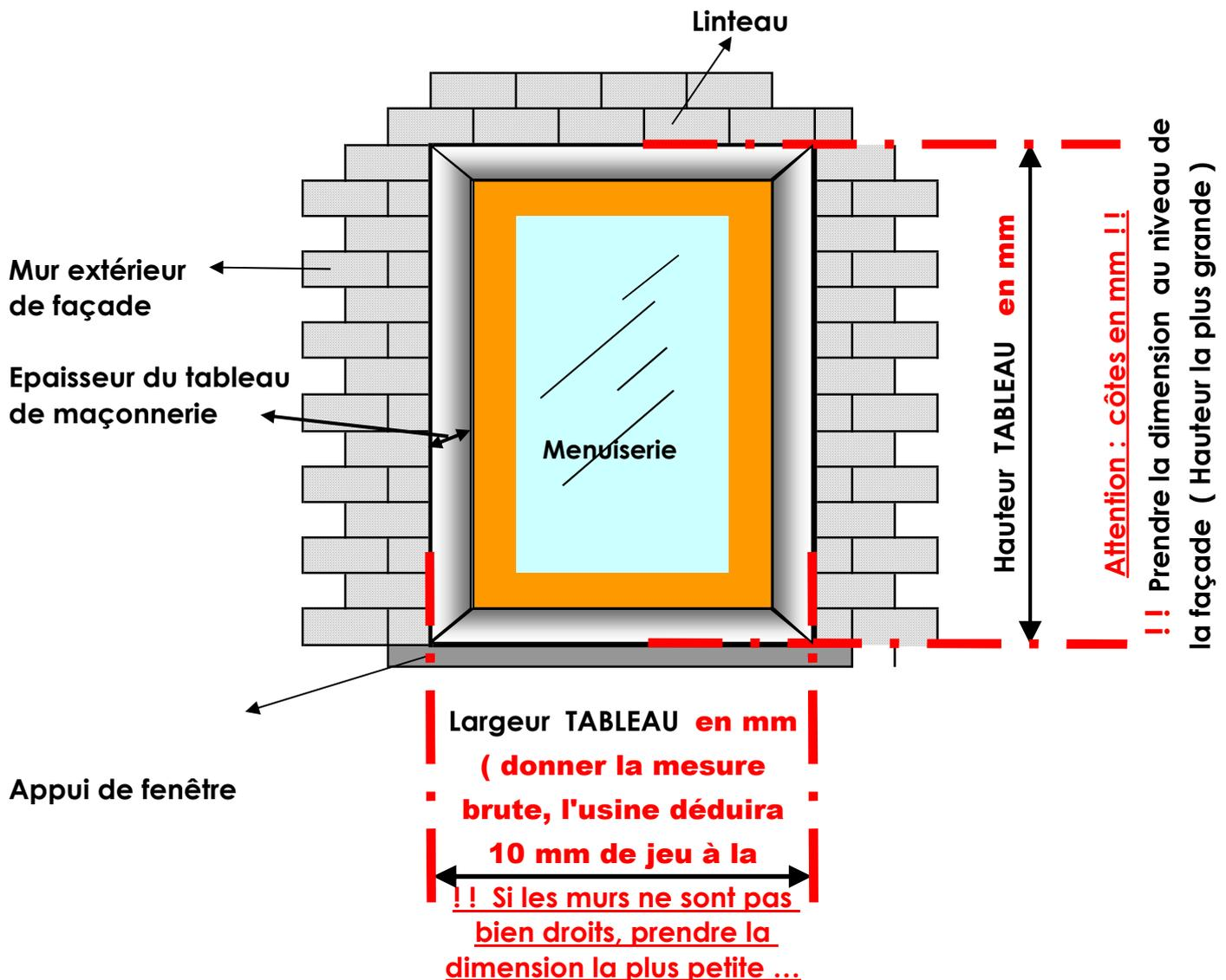
A la fabrication, l'usine déduira un " jeu " de 10 mm sur la largeur " tableau "
