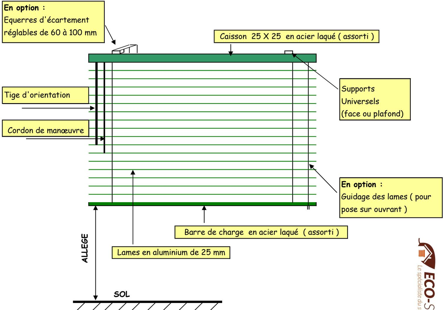
**OPTIONS :** **GUIDAGE** : fixation basse du câble par EQUERRE ( sur paroi verticale )
