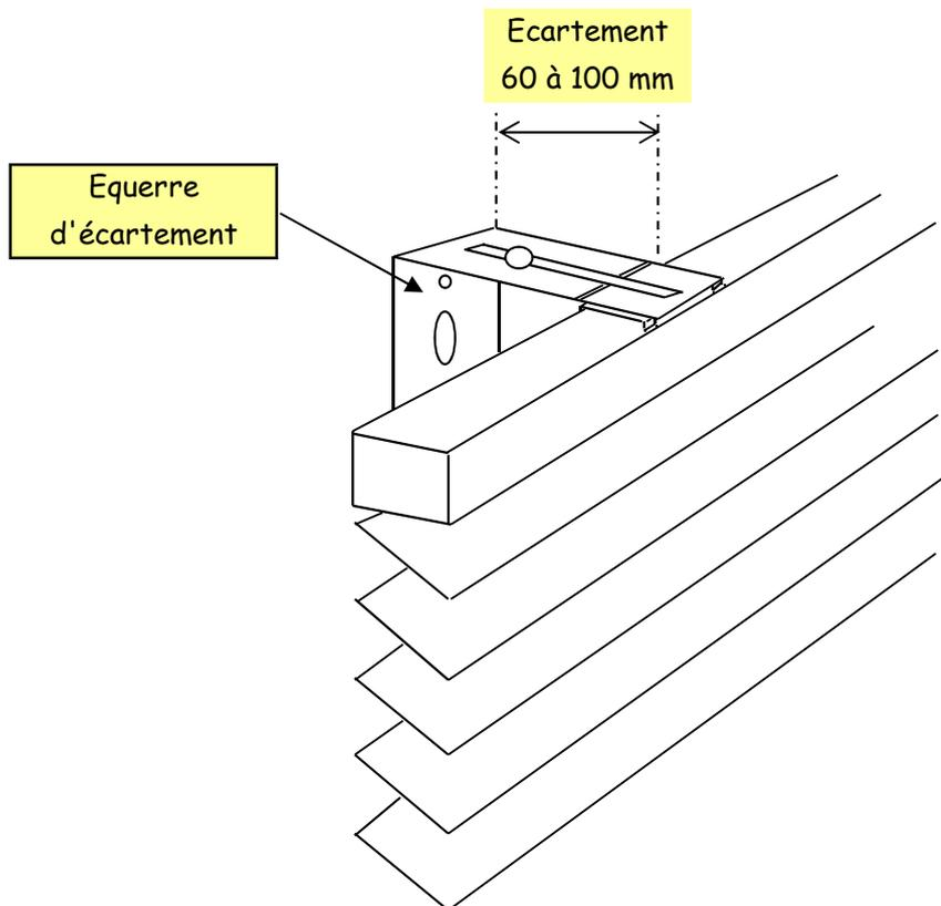
10) **L'option " SANS PERCAGE " : SUPPORTS et FIXATION de guidage à PINCER sur l'ouvrant**
