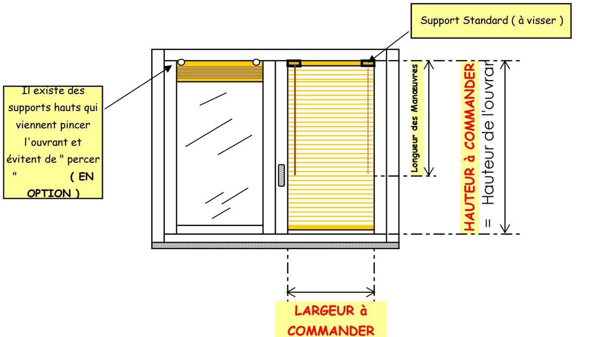
= Largeur de vitrage + recouvrement ( 2 x 10 mm ? )
