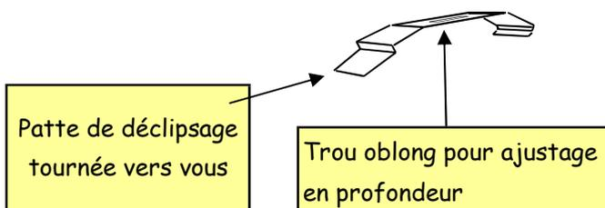
1 ) Placer les clips sur le profil, à environ 50 mm des extrémités du rail de store :
