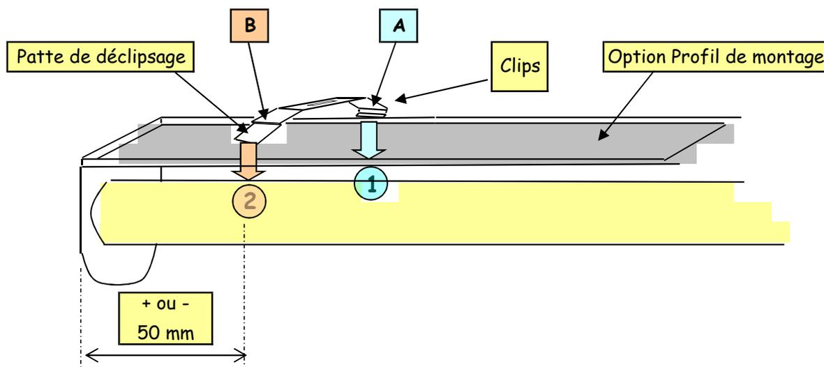
2) Placer le store à l'endroit prévu, et, tracez l'emplacement des Clips sur le plafond ou sur le mur,
