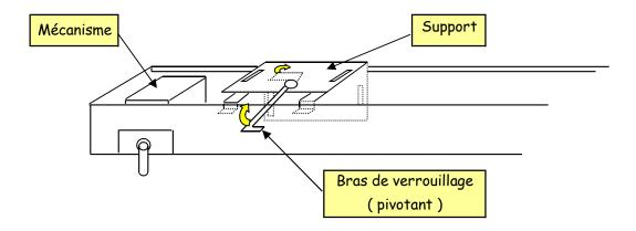
2) Placer le store à l'endroit prévu, et, tracez l'emplacement des supports sur le mur ou sur le plafond,
